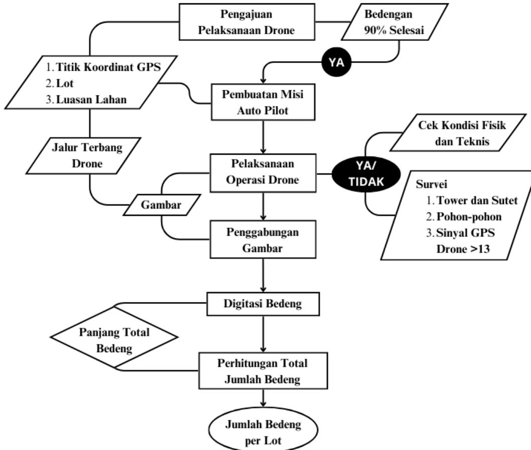
**Gambar 4.18** Alur Proses Perhitungan Bedengan (MKI, 2024)
